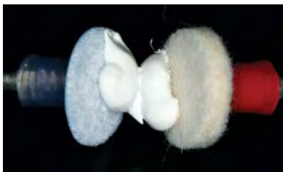
Figura 14 - Discos de feltro para polimento com pasta de polimento (Diamond, Diamond Flex e Diamond Excel - FGM)
