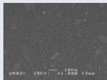
REM nach dem Finieren und Polieren
