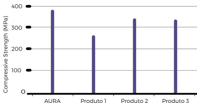
A morfologia única da carga UAD propicia uma interface de resistência extremamente alta que pode suportar as elevadas forças compressivas.
