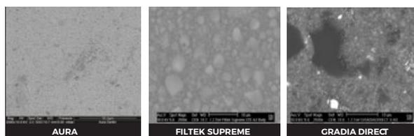
As imagens de microscopia eletrônica de varredura mostram a diferença no tamanho das partículas entre os três compósitos. As micropartículas pré-polimerizadas da Aura são mais resistentes do que as micropartículas padrão. Isso possibilita um polimento rápido e fácil garantindo um acabamento com alto brilho duradouro, sem o "efeito plucking" de partículas grandes. Compósitos com cargas maiores não conseguem alcançar o mesmo resultado clínico.
